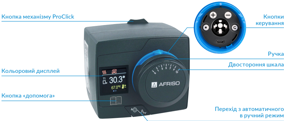
Рис. 1. Конструкція приводу-контролера постійної температури ACT ProClick
