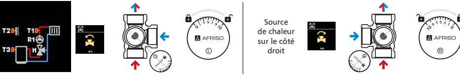
Fig. 9. Schéma avec vanne mélangeuse 3 voies ARV Vario ProClick (chauffage au sol ou radiateur)
