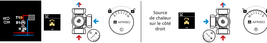
Fig. 10. Schéma avec vanne mélangeuse 3 voies ARV Vario ProClick (chauffage au sol ou radiateur). Pour connecter la régulation à un autre régulation (communication BUS)
