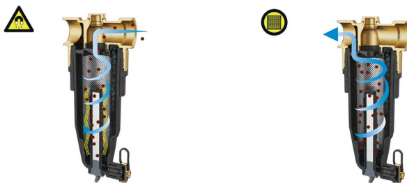
Рисунок 13: Стадії фільтрації в сепараторі ADS 181
