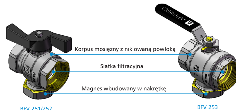
Rys. 2. Budowa zaworu kulowego BFV
