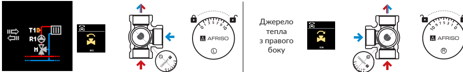
Рис. 10. Схема з 3-ходовим змішувальним клапаном ARV Vario ProClick на подаванні (поверхневе або радіаторне опалення). Вибирається, щоб під'єднати черговий контролер до зв'язку BUS
