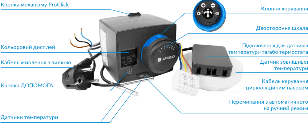
Рис. 1. Конструкція погодозалежного приводу-контролера ARC 345 ProClick
