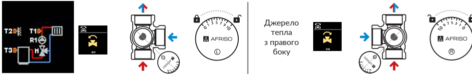
Рис. 9. Схема з 3-ходовим змішувальним клапаном ARV Vario ProClick на подаванні (поверхневе або радіаторне опалення)
