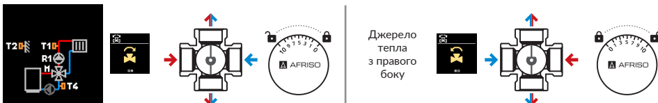
Рис. 11. Схема з 4-ходовим змішувальним клапаном (поверхневе або радіаторне опалення) з функцією захисту температури повернення
