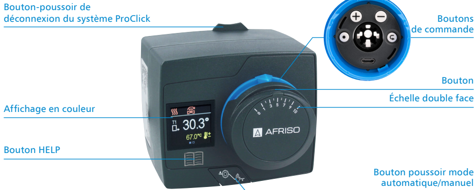
Fig. 1. Construction du régulateur de température constante ACT ProClick
