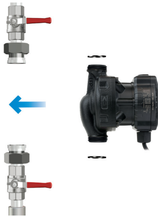
Рис. 2. Розташування запірних кранів відносно насоса APH
