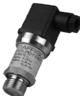
Rys. 6. DMU 03 VM (Ex), wersja przemysłowa z wysuniętą membraną (dla cieczy lepkich, o wysokiej lepkości lub krystalizujących)
