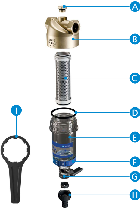
Rys. 2. Budowa filtra do wody AWF
