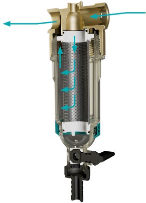
Rys. 1. Schemat przepływu wody przez filtr AWF
