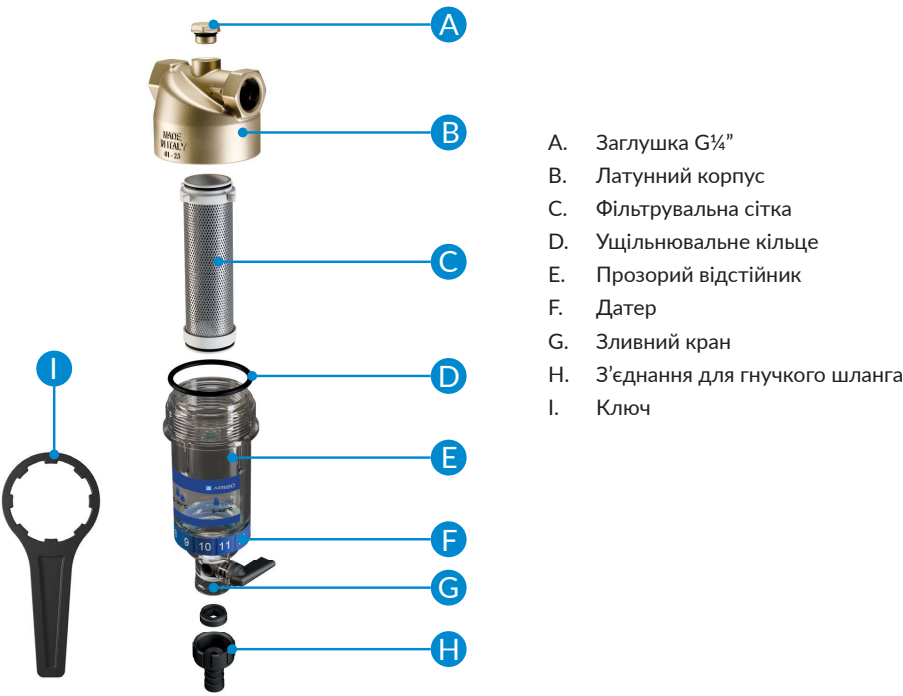
Рис. 2. Конструкція фільтра для води AWF
