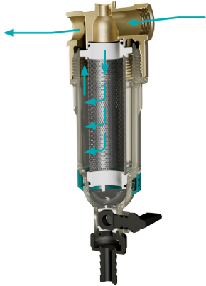
Рис. 1. Схема проходження води через фільтр AWF
