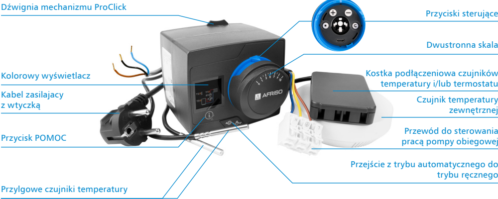
Rys. 1. Budowa regulatora pogodowego ARC 345 ProClick
