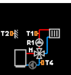
Rys. 11. Schemat z zaworem mieszającym 4-drogowym (ogrzewanie płaszczyznowe lub grzejnikowe) z aktywną funkcją ochrony temperatury powrotu
