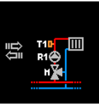
Rys. 10. Schemat z 3-drogowym zaworem mieszającym ARV Vario ProClick na zasilaniu (ogrzewanie płaszczyznowe lub grzejnikowe). Wybierany, w celu podłączenia kolejnego regulatora w komunikacji BUS
