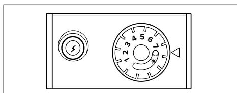
Nyomja be teljesen a B gombot, tartsa nyomva, és közben nyomja be a C piezo elektromos gyűjtőt.
