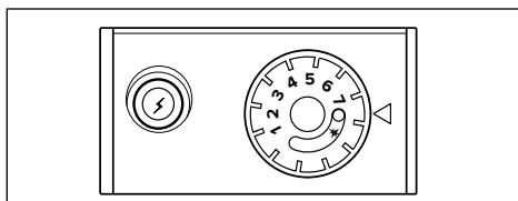
Stlačte otočný ovládač B až na doraz, pridržte ho v stlačenom stave a súčasne stlačte piezoelektrický zapaľovač C.
