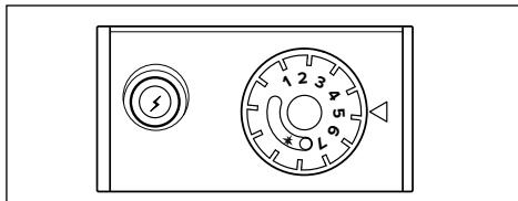
Pentru reducerea consumului de gaz și rularea eficientă a aparatului, se recomandă folosirea setării 5 (circa 60 °C). Această temperatură reduce de asemenea formarea depunerilor în încălzitorul de apă, atunci când apa folosită este foarte dură (conținut excesiv de calciu).
