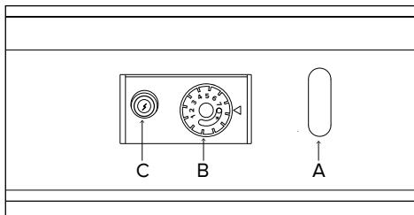
Přestavte otočný ovladač B z polohy **O** (vypnuto) do polohy **★** (zapnutý pilotní hořák).
