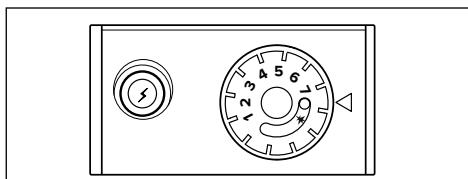
Stiskněte otočný ovladač B až na doraz, přidržte jej ve stisknutém stavu a současně stiskněte piezoelektrický zapalovač C.
