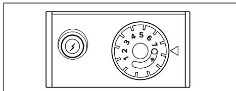
Apăsați complet în interior butonul B și mențineți; acum apăsați aprinzătorul piezoelectric C.
