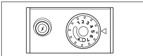
Pro zajištění úsporné spotřeby plynu a lepší účinnosti zařízení se doporučuje ponechat otočný ovladač v poloze odpovídající označení 5 (přibližně 60 °C).
