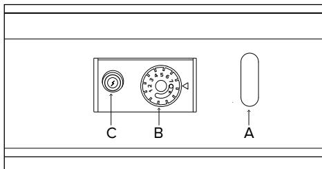
Prestavte otočný ovládač B z polohy O (vypnutý) do polohy ★ (zapnutý pilotný horák).
