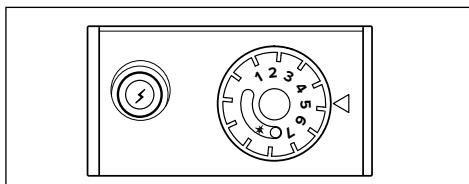
Aby zmniejszyć zużycie gazu i umożliwić wydajniejszą pracę urządzenia zaleca się ustawienie pokrętła na 5 (około 60°C).
